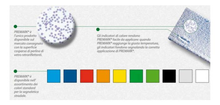
**PREMARK®** contiene microsfere di vetro atte a garantire un'ottima retroriflessione: questo è un requisito primario per la sicurezza ed il miglioramento delle condizioni di guida dopo il tramonto. Le microsfere sono sparse in modo omogeneo su tutta la superficie, così come all'interno dei tre millimetri di spessore del prodotto. Il risultato di questa tecnologia garantisce la durata della retroriflessione per tutto il ciclo di vita del prodotto.
